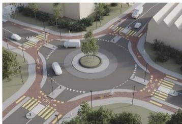
Un altro tipico scenario di applicazione del guado con diritto di precedenza è la rotatoria, dotata di pista ciclabile a sviluppo perimetrale; nei centri abitati neerlandesi, dove il livello di sicurezza raggiunto è elevato, è una soluzione ormai di casa, tanto da essere preferita, ove possibile o opportuno, rispetto agli incroci convenzionali con o senza semafori. In Svizzera i percorsi ciclabili si interrompono prima della rotatoria, imponendo complesse manovre da eseguire
