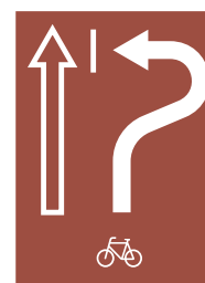
Fig. 412 Panneau souvent utilisé pour le tourner-à-gauche indirect
