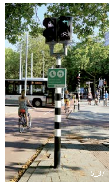
Un feu supplémentaire permet d'indiquer aux cyclistes la combinaison de phases de vert la plus rapide pour le tourner-à-gauche.
