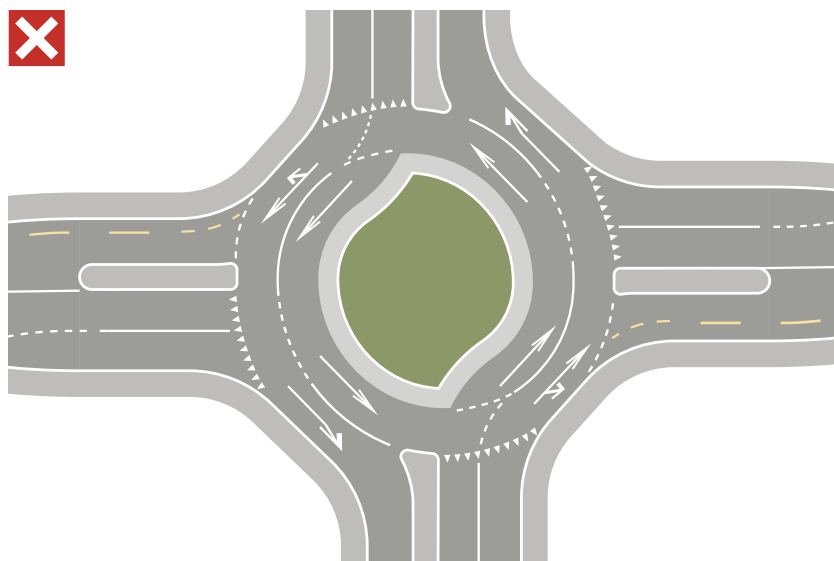
Fig. 631 Les turbo-giratoires sont trop complexes et également exigeants pour les automobilistes, donc non cyclo-conformes
