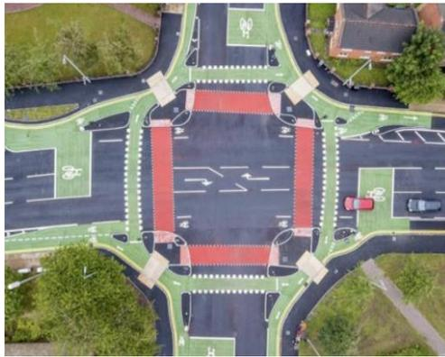
Abbildung 54: Testbetrieb in Manchester, LSA-Kreuzung mit umlaufendem Radweg und Fussgängerführung auf Innenseite
