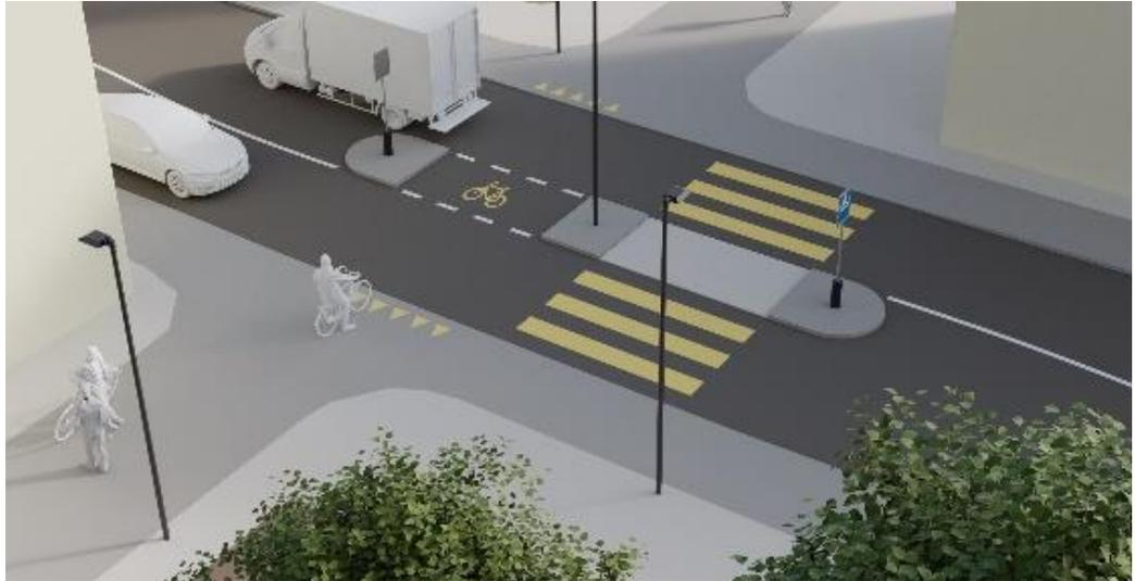
Abbildung 98: Standard für Grundelement C Veloquerung ohne Vortritt
