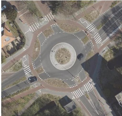
Abbildung 23: Kreisel im Einrichtungsverkehr, Kreiseldurchmesser Fahrbahn 26 m
