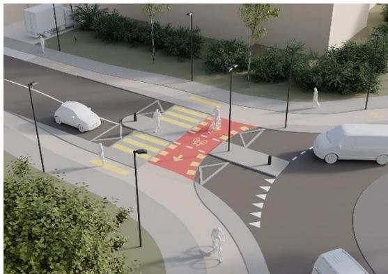
Abbildung 94: Ausgestaltung mit Vertikalversatz
