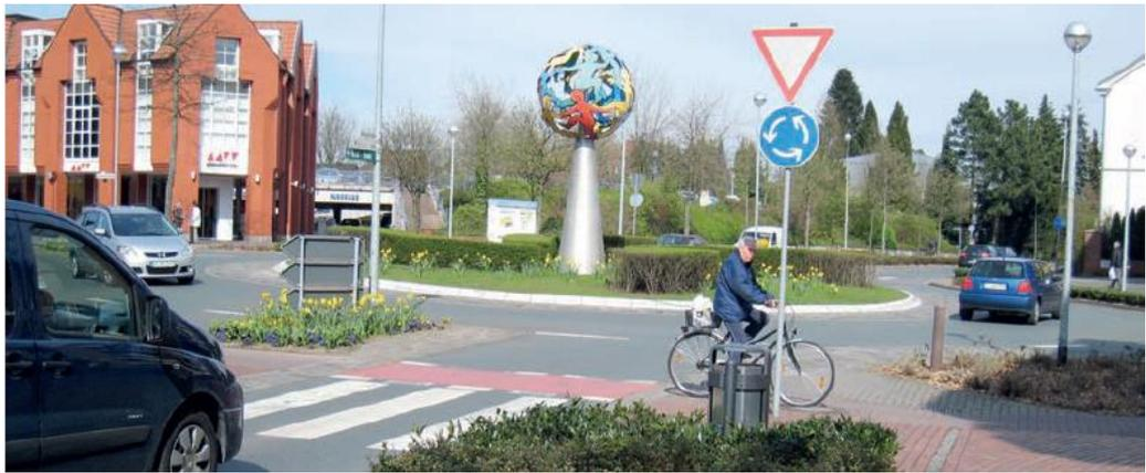
Abbildung 33: Beispiel eines umlaufenden Radwegs mit Furten
