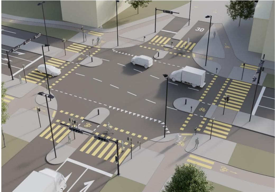
Abbildung 104: LSA-Kreuzung mit umlaufendem Radweg mit vortrittsberechtigter Furtmarkierung
