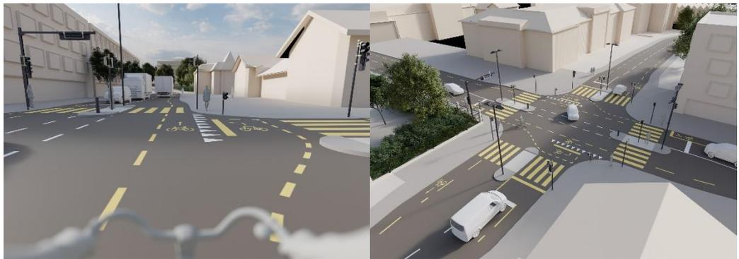
Abbildung 112: Indirektes Linksabbiegen aus der Perspektive der Velofahrenden
