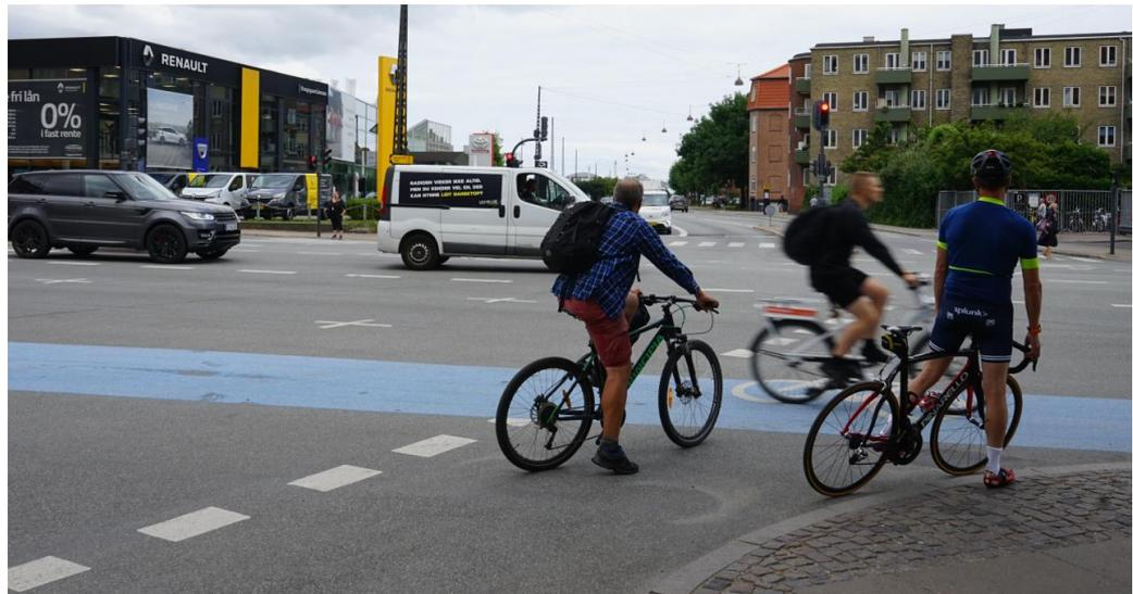
Abbildung 61: Aufstellbereich für indirektes Linksabbiegen in DK
