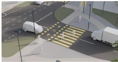
Schlüsselement der Radweglösungen in Knoten ist die vortrittsberechtigige Velofurt (in Analogie zum Fussgängerstreifen). Mit Blick auf die Erfahrungen der Niederlande soll die Velofurt um 5 m zurückversetzt werden. Alternative Möglichkeit ist ein Rückversatz um 2 m, kombiniert mit einer Anrampung. Die
