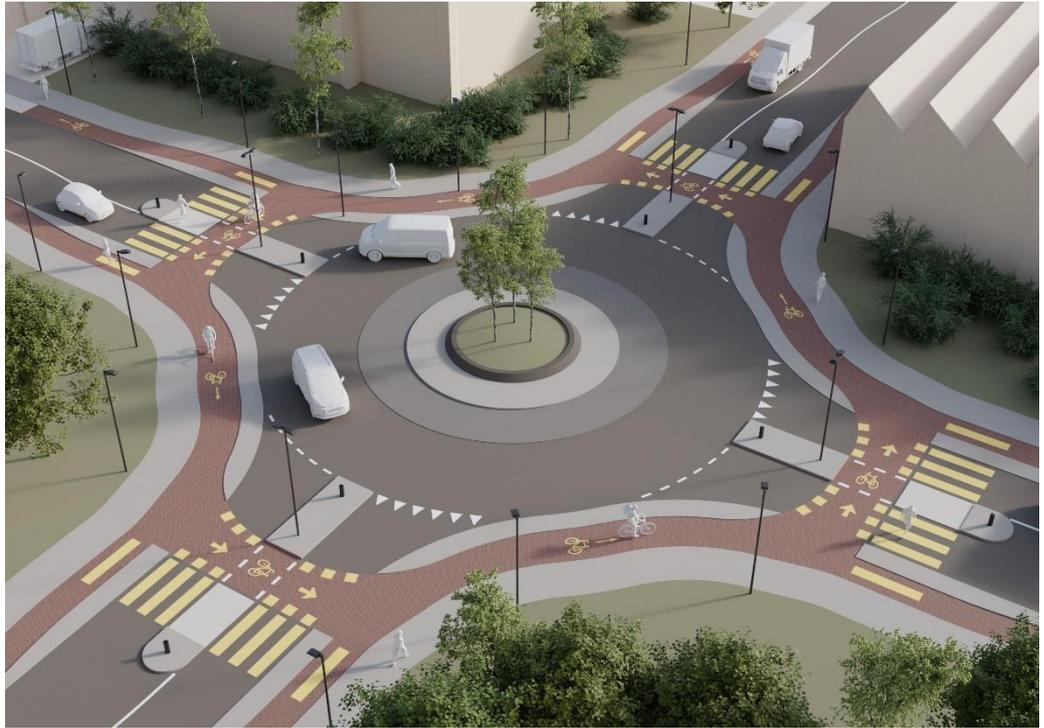
Abbildung 93: Umsetzung mit rötlichem Belag
