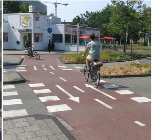
Abbildung 24: Kreisel mit umlaufendem Zweirichtungsradweg
