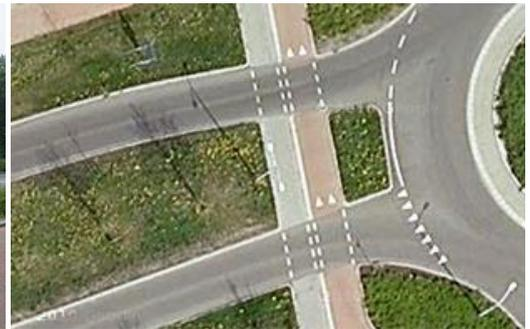
Abbildung 39: Ausgestaltung Velofurt ohne Vortritt mit Führungslinie
