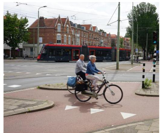
Abbildung 48: Umlaufender Radweg im Einrichtungsbetrieb
