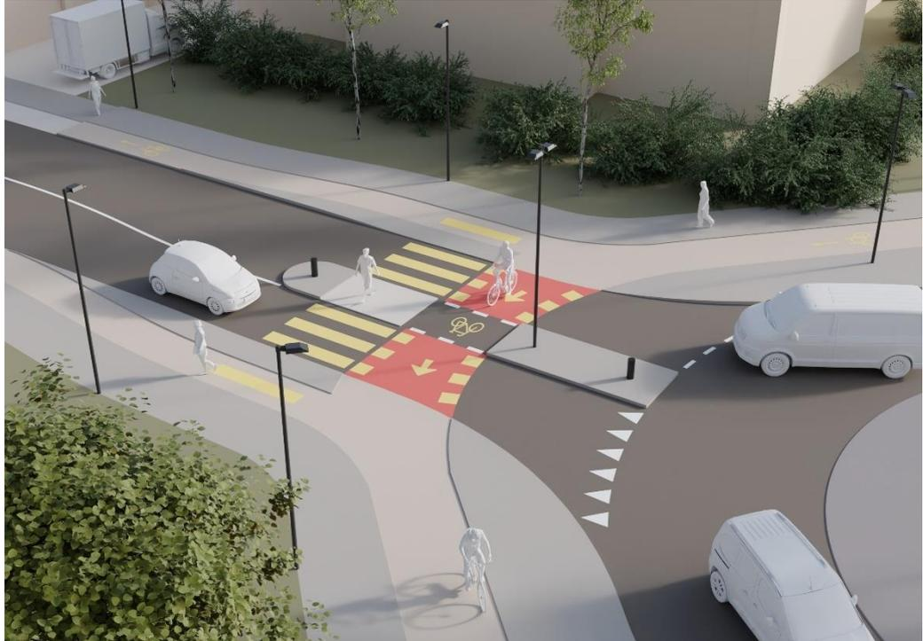
Abbildung 90: Kreisel mit umlaufendem Radweg mit vortrittsberechtigter Veloquerung
