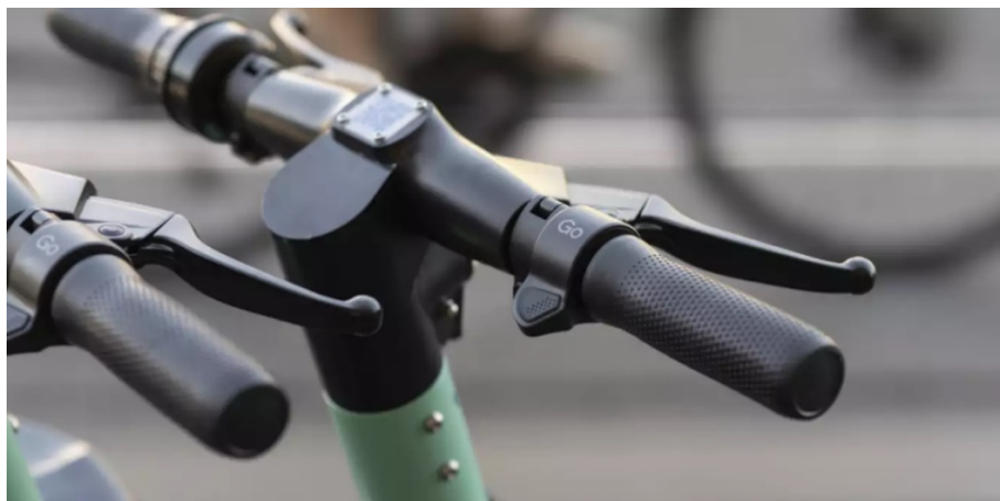
Illustration 10 Les petits véhicules électriques doivent être au moins équipés d'une barre de maintien et de deux freins indépendants
