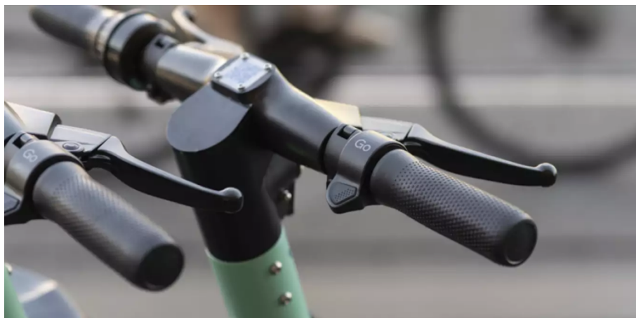
Abbildung 10 Elektrische Kleinfahrzeuge müssen mindestens über eine Haltestange und zwei unabhängige Bremsen verfügen
