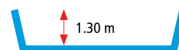
Fig. 703 la hauteur du garde-corps sur une passerelle et ses rampes d'accès où circulent des cyclistes est d'au moins 1.30 m
