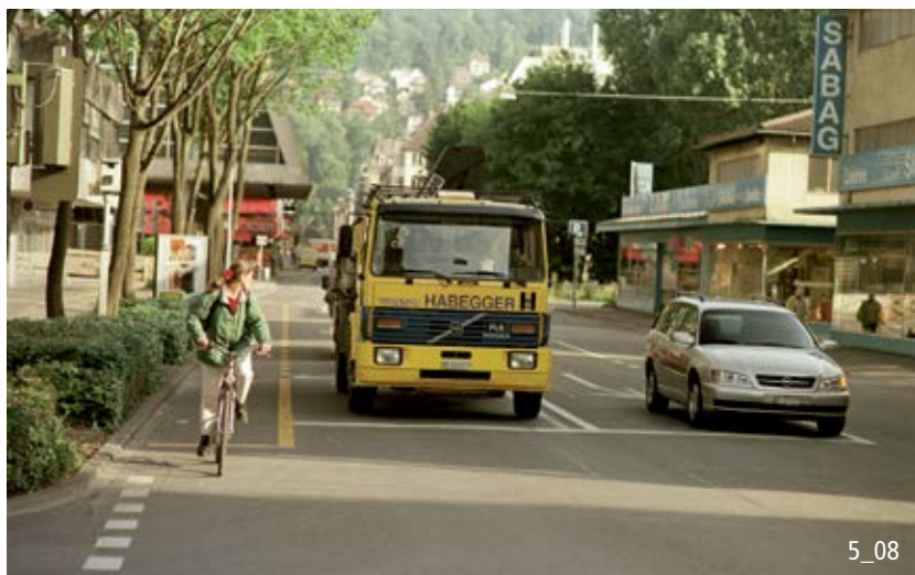
Ligne d'arrêt avancée associée au vert anticipé pour les cycles.
