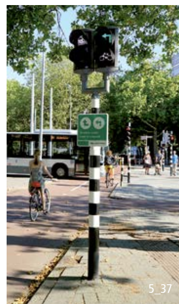
Un feu supplémentaire permet d'indiquer aux cyclistes la combinaison de phases de vert la plus rapide pour le tourner-à-gauche.
