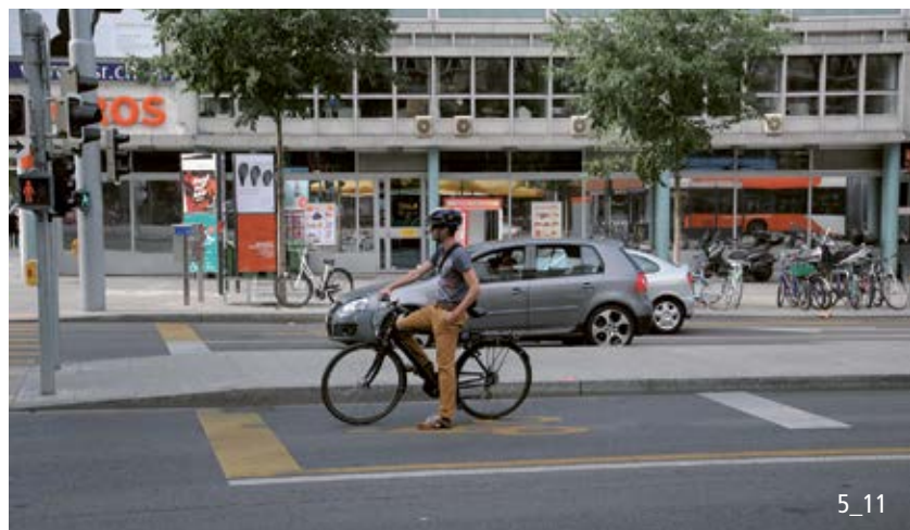
Sas pour cyclistes, profondeur min. 4.0 m.
