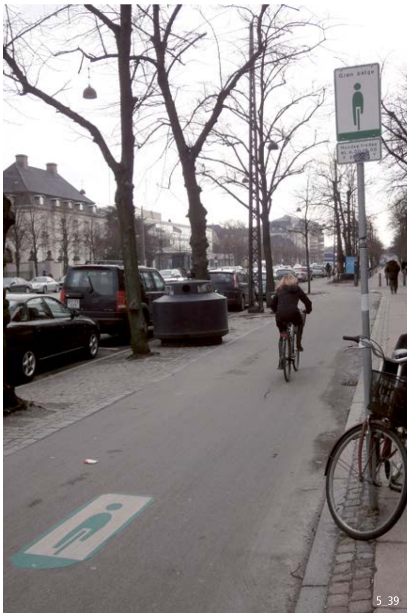
Onde verte pour les cycles : panneau avec indication de la période d'activation et pictogramme (Danemark).
