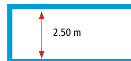
Fig. 702 La hauteur des passages inférieurs est d'au moins 2.50 m et dépend grandement de leur longueur
