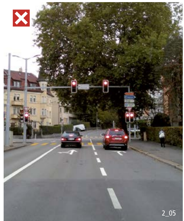
Combinaison de flèches de direction à éviter absolument, car non cyclo-conforme.
