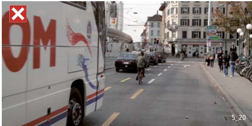
Zu schmale oder zu lange Radstreifen in Mittellage sind nicht veloverträglich.
