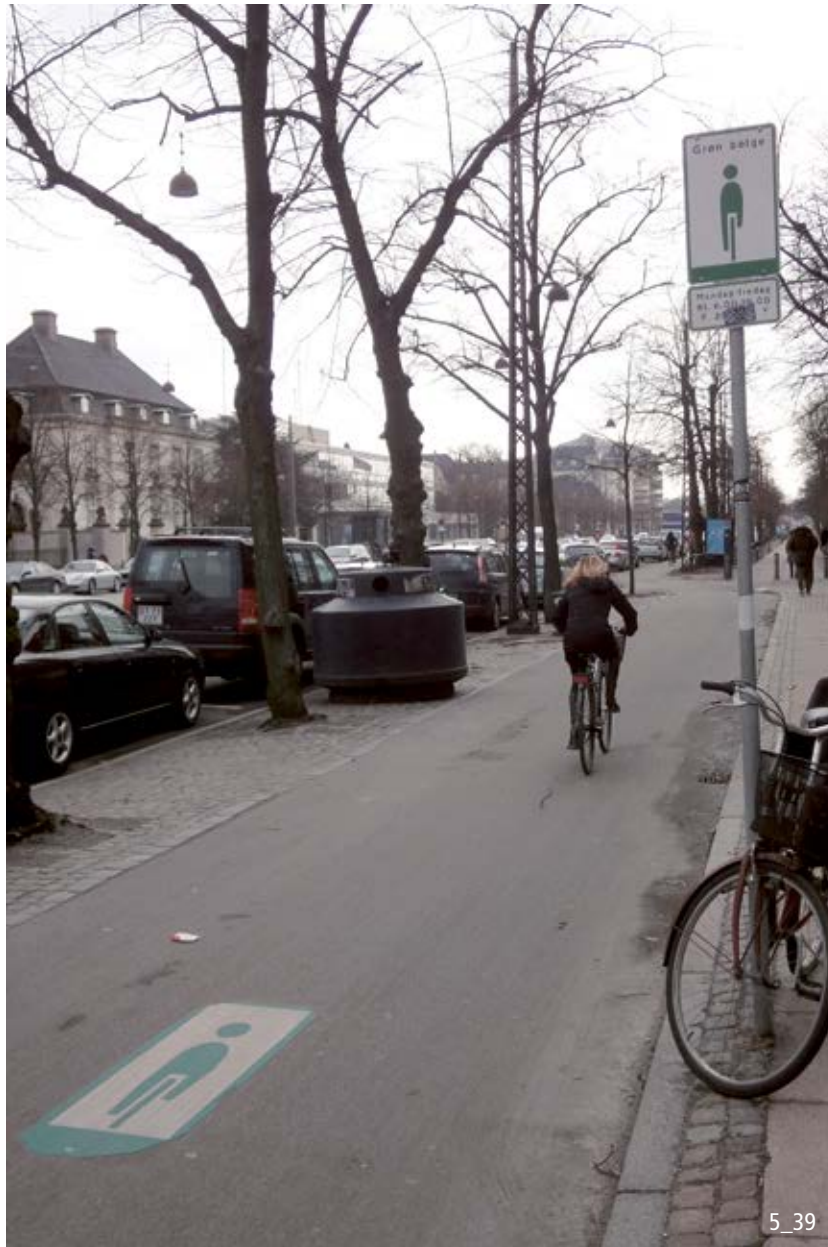
Grüne Welle für Veloverkehr: Tafel mit Angabe des geltenden Zeitraums und Piktogramm (Dänemark).
