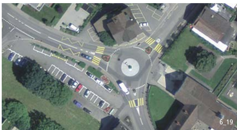
Minikreisel d = 22 m, Mittelinsel gepflästert d = 10 m, Kandelaber im Kreiselmittelpunkt.
