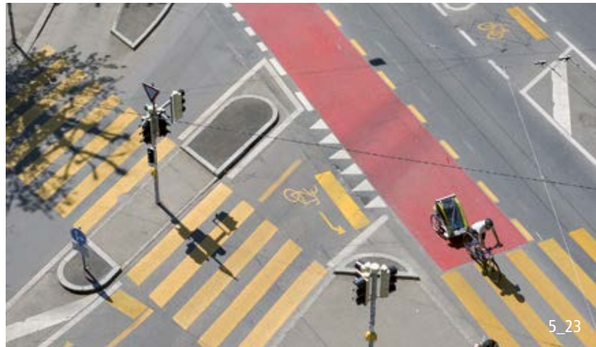
Indirektes Linksabbiegen auf der Fahrbahn.
