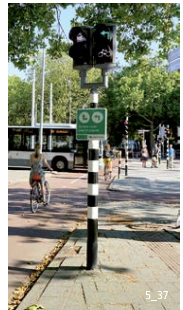
Mit einem zusätzlichen Signal kann für die Linksabbiegebeziehung die schnellste Kombination der Grünphasen angezeigt werden.
