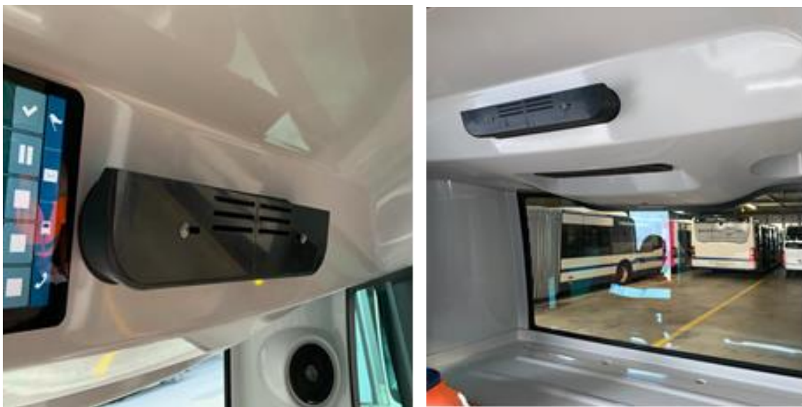
Abbildung 46: Montierte Umlenklende im Shuttle
