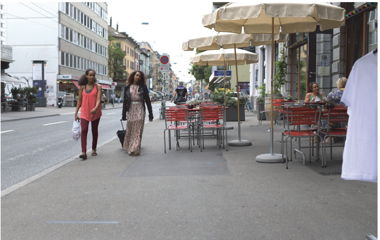
Langstrasse (Bedeutung: regional/stadtweit): keine ausreichende lichte Breite aufgrund Aussenbestuhlung, keine ausreichenden Umfeldzuschläge zum Strassencafé und zur Fahrbahn hin.
