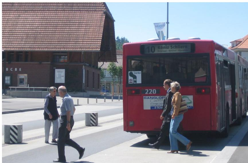
Abb. 7 – Köniz BE: Die Fahrbahnhaltestelle ermöglicht den aussteigenden Fahrgästen die Strassenquerung direkt im Bereich des haltenden Busses.
