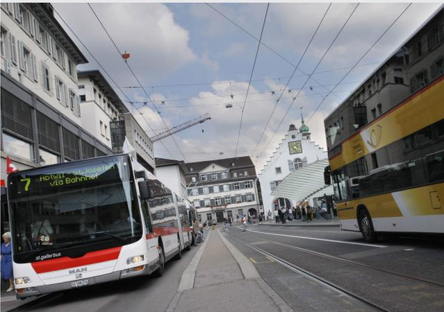
St.Gallen: Die Anordnung bedingt ein System mit Durchmesserlinien mit kurzen Haltzeiten. Fahrplanausgleichszeiten werden an den Endhaltestellen gewährleistet. Der Vorteil liegt im geringen Platzverbrauch und der schnellen Abwicklung des Fahrgastwechsels. Nachteilig ist, dass das Umsteigen zwischen den Bussen und das Abwarten von Zugsanschlüssen erschwert wird.
