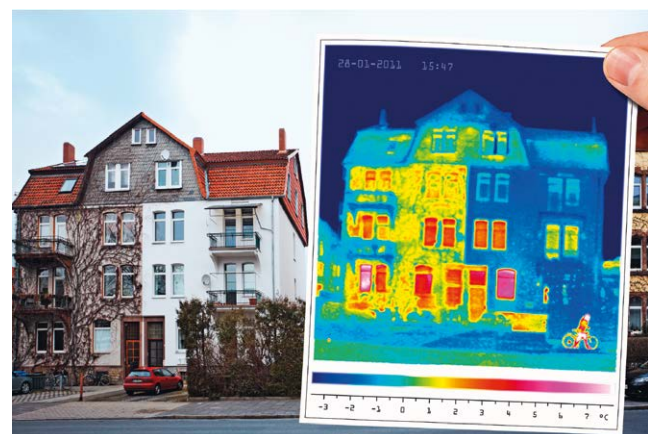
Bilan thermique : façade assainie (à droite) et non assainie
