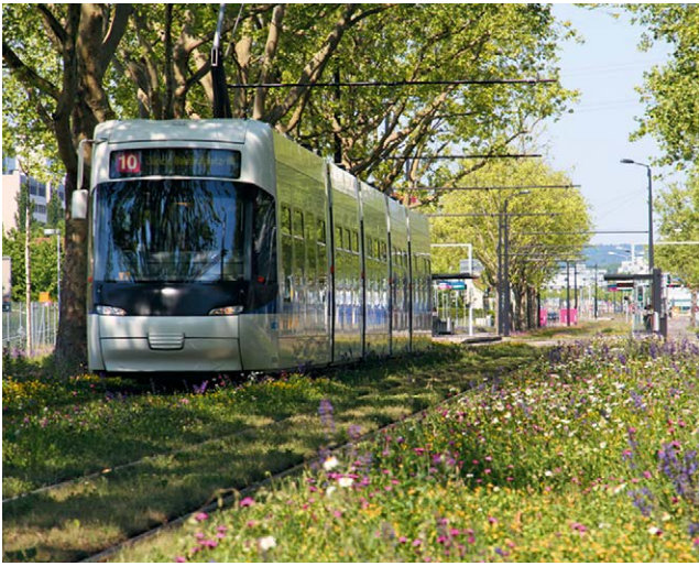
Abbildung 49 Das Trasse der Glattalbahn ist begrünt und durch Bäume beschattet
