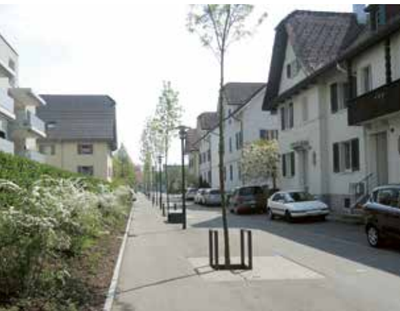
Weiche Trennung von Geh- und Fahrbereich mit Bäumen, Beleuchtung und Sitzbänken in einer Begegnungszone.
