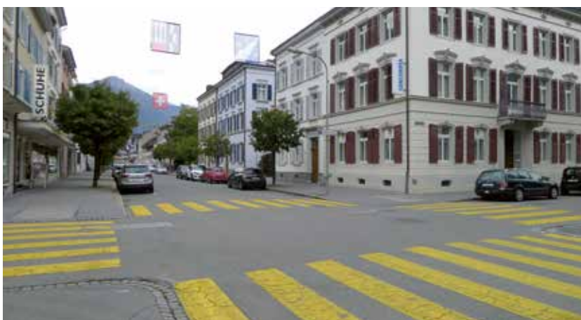
Zwei Beispiele von nicht zurückgesetzten Fussgängerstreifen, oben über vortrittsbelastete Strasse, unten über Strasse mit Rechtsvortritt.
