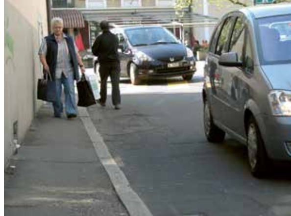
Zu schmales Trottoir entlang stark belasteter Strasse.
