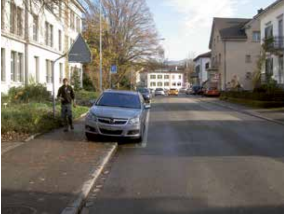
Ungünstige Aufteilung des Strassenraums. Die schmalen Trottoirs werden durch die Markierung von Parkplätzen noch enger.
