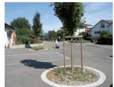
Platz für Fussverkehr und Bäume dank Trottoirüberfahrt und Verkleinerung der Abbiegeradien.
