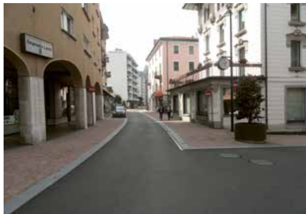
Dank Redimensionierung der Abbiegeradien wurde eine Aufenthaltsfläche geschaffen.
