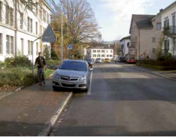
Répartition de l'espace-rue défavorable aux piétons. Sur les trottoirs, déjà étroits, le passage est rendu encore plus exigu par le marquage de places de stationnement.
