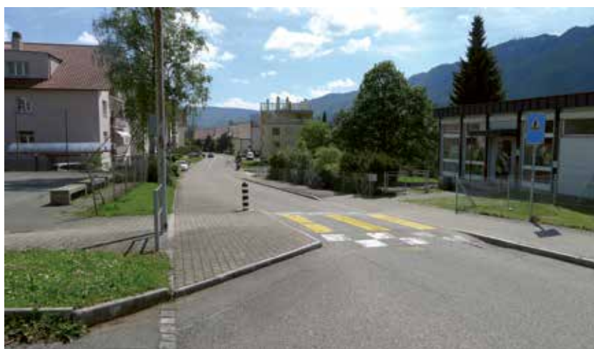
Rétrécissement unilatéral complété d'un décrochement vertical devant une école enfantine.
