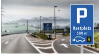
Dynamische Signalisation der freien Ladeplätze auf Raststätten und Rastplätzen in Echtzeit (49)
