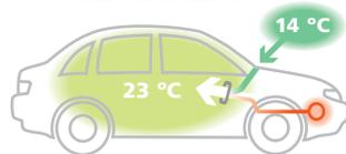
L'aria esterna (per esempio 14 °C) viene raffreddata fino a 3 °C. Questo consuma circa il 5% di benzina (2,5% di diesel). Solo poi l'aria viene nuovamente riscaldata alla temperatura interna desiderata (ottimale: 23 °C).
