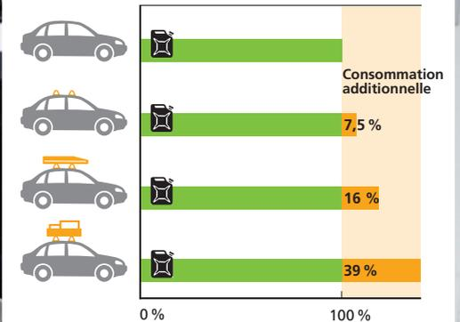
A 120 km/h, la galerie augmente la consommation à cause de la plus importante résistance de l'air: jusqu'à 39 % avec charge, et jusqu'à 7,5 % sans.
