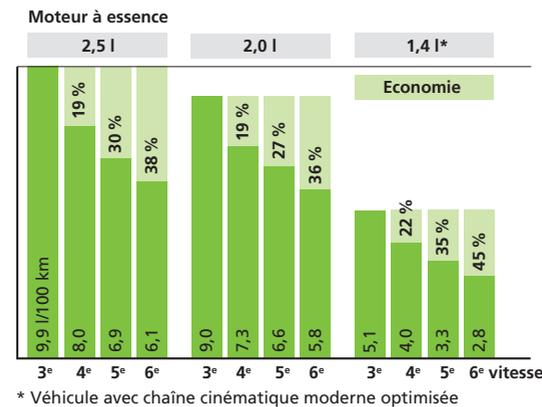
Une vitesse constante avec le rapport le plus élevé économise du carburant. Celui qui roule avec un moteur de 2 litres de cylindrée régulièrement en 6<sup>e</sup> au lieu de la 3<sup>e</sup> économise jusqu'à 36%.
