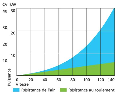
La résistance au roulement et la résistance de l'air augmentent avec la vitesse, la consommation de carburant augmente donc elle aussi.
