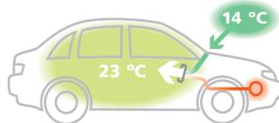
L'air extérieur (14 °C, p.ex.) est refroidi jusqu'à 3 °C. Cela consomme environ 5 % de carburant (2,5 % de diesel). Ce n'est qu'à ce moment que l'air est de nouveau chauffé à la température intérieure souhaitée (idéal 23 °C).
