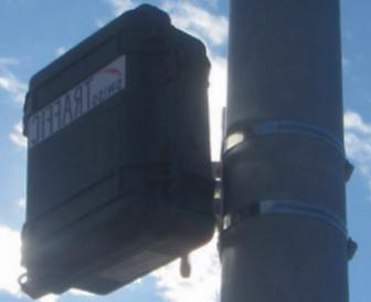
Der multimodale «plug & count» IoT-Radar überträgt die Zähldaten u.a. auch via LoRa-Netzwerk.
