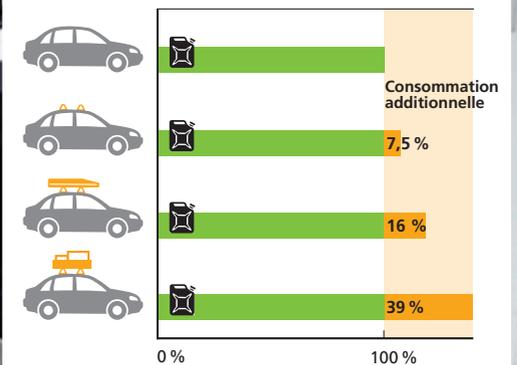
À 120 km/h, la galerie augmente la consommation à cause de la plus importante résistance de l'air: jusqu'à 39 % avec charge, et jusqu'à 7,5 % sans.
