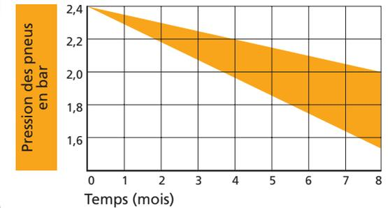
Le graphique montre la marge de perte d'air pour des pneus conventionnels. Exemple: en 4 mois, la pression des pneus diminue de 2,4 bar à 2,0 ou 2,2 bar, c.-à-d. de près de 10 %.
