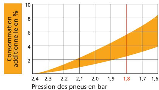
La marge varie selon le niveau de gonflage, le type de pneus et la vitesse. Exemple: avec 1,8 bar, la consommation augmente jusqu'à 6 %.
