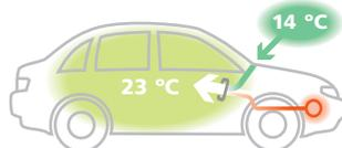
L'air extérieur (14 °C, p.ex.) est refroidi jusqu'à 3 °C. Cela consomme environ 5 % de carburant (2,5 % de diesel). Ce n'est qu'à ce moment que l'air est de nouveau chauffé à la température intérieure souhaitée (idéal 23 °C).
