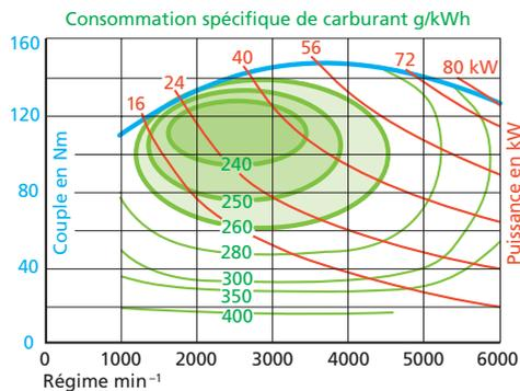
Le plus efficace est de rouler à pleins gaz entre 1500 et 3500 tours/min (vert foncé). Le principe est presque le même pour les moteurs diesel.
