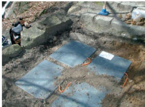
Abbildung 6: Hintereinanderliegende Sensoren ermöglichen die Erfassung der Gehrichtung.
