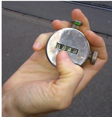
Abbildung 3: Die mechanische Zählung benötigt wenig Material, minimale technische Kenntnisse und ist kostengünstig. Ein einfacher mechanischer Zähler genügt.
