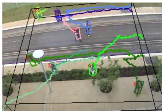
Abbildung 13: Videoanalyse-Software ermöglicht die Verfolgung von Bewegungsmustern.
