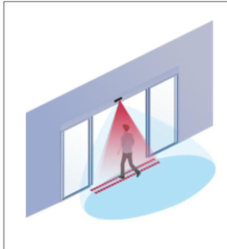
Abbildung 11: In- / Out-Zählung mit vertikal installiertem Aktiv-Infrarotmessgerät
