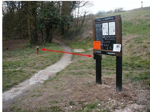
Abbildung 10: Aktiv-Infrarot-Systeme mit Doppelbox.
