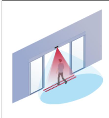
Figure 11 Comptage des entrées et sorties avec un capteur infrarouge actif.
