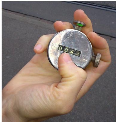
Figure 3 Le comptage manuel nécessite peu de matériel, de connaissances techniques et de ressources financières. Il peut s'effectuer au moyen d'un simple compteur mécanique.
