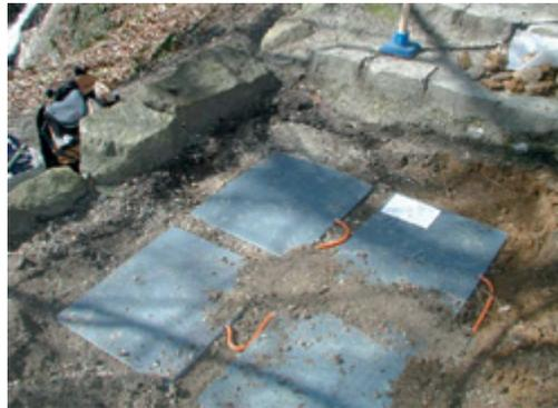
Figure 6 Des capteurs placés l'un derrière l'autre permettent de distinguer la direction des déplacements.
