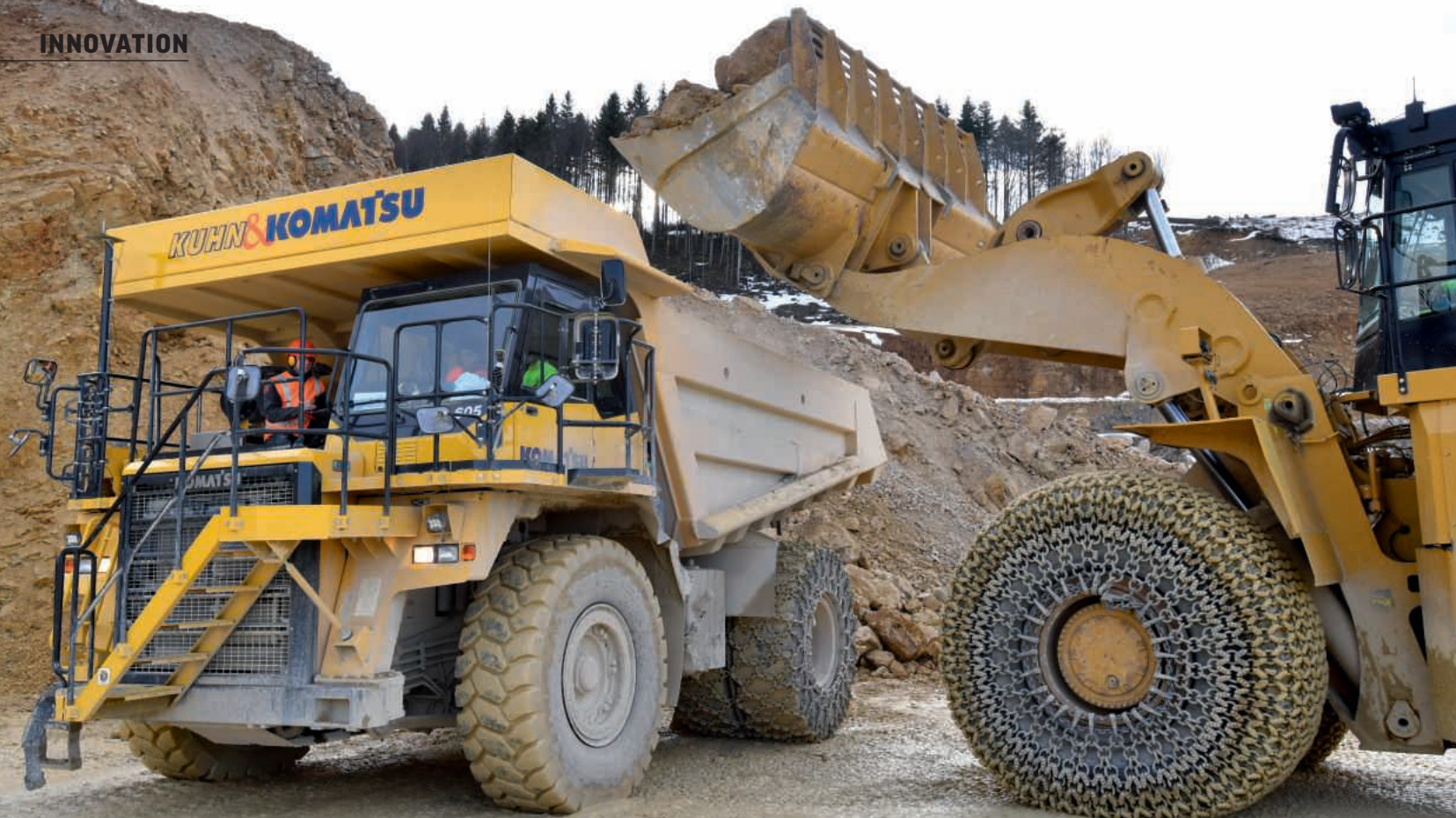
Une image du passé: jusqu'à l'année dernière, le basculeur Komatsu roulait au diesel entre la carrière et la fabrique de ciment. Dans quelques mois, il devrait faire exactement le même travail, mais électriquement.
