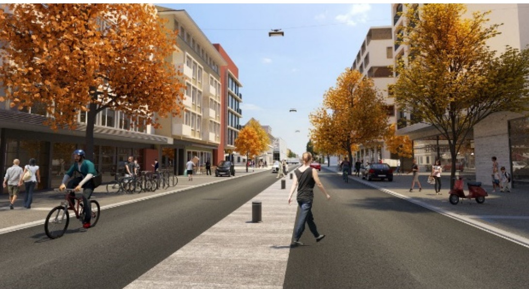
Landstrasse, Wettingen: Breite Gehbereiche (7.5 m), Mischverkehr, Temporeduktion, vereinfachtes Queren dank Mehrzweckstreifen, Interaktion mit Verkehrsströmen dank Kurzzeitparkplätze (Quelle: vdw, metron, roth, Gde. Wettingen)
