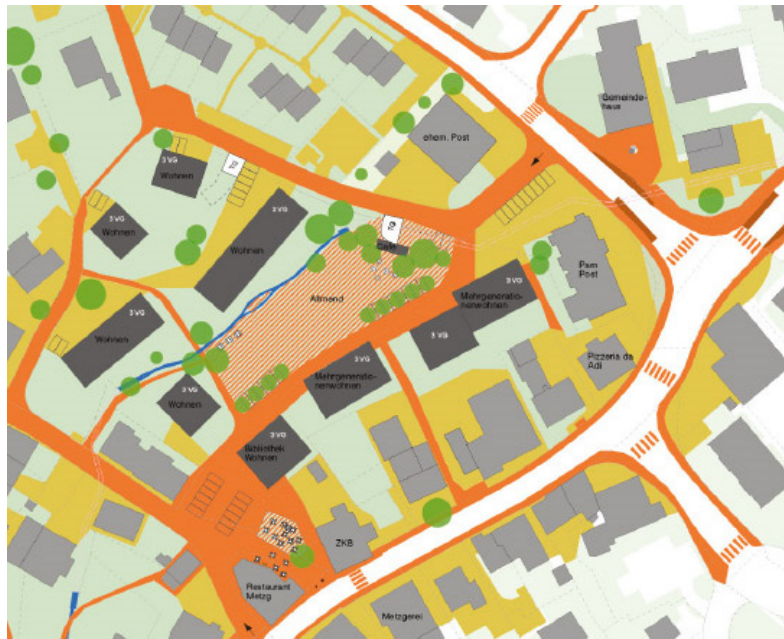
Birmensdorferstrasse, Zürich: vergrößerter Platzbedarf durch Trennung der Verkehrssysteme (Bild vdw)
