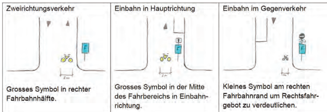
Abb. 303: Markierung 'Velostrasse': Beginn der Velostrasse
