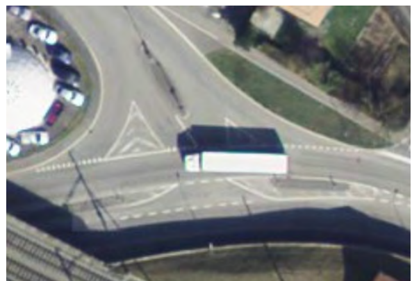
Abbildung 38 Einmündung mit ausgeweitetem Mittelbereich
