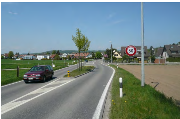
Abbildung 40 Torwirkung einer Mittelinsel bei einer Ortseinfahrt
