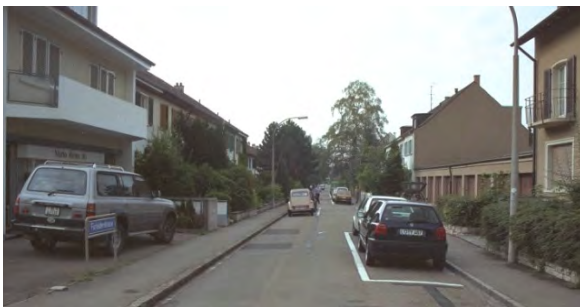
Abbildung 45 Versetzte Parkfelder in einer Tempo-30-Zone
