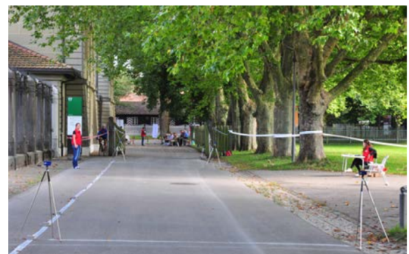
Abbildung 58 Kontrolle der real gefahrenen Geschwindigkeiten mittels Lichtschranke
