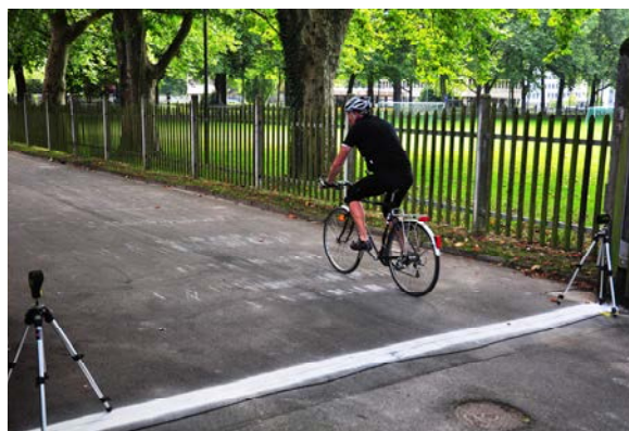
Abbildung 52 Proband schliesst die Augen und stellt sich vor, das Versuchsfahrzeug fahre mit konstanter Geschwindigkeit weiter
