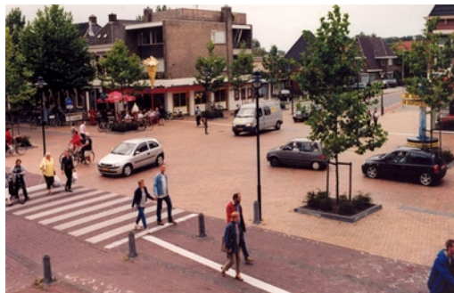
Le même carrefour aménagé en Shared Space : suppression des feux tricolores, mixité des usages (les espaces dédiés aux modes actifs sont tout de même identifiés)
