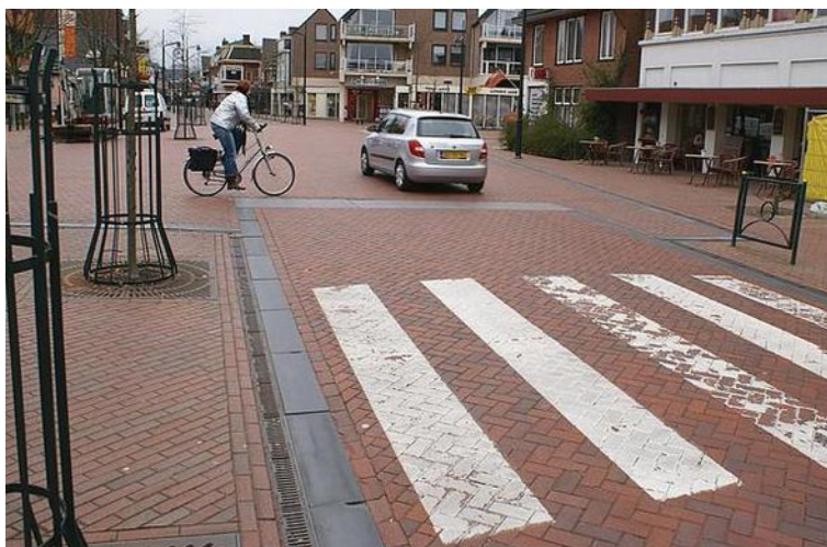
Haren, rue commerçante après aménagement : l'espace piéton est au même niveau que la chaussée, mais en est séparé par des éléments de mobilier urbain
