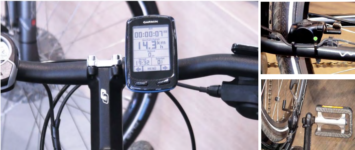
Abbildung 10: Der eingesetzte Fahrradcomputer „Garmin Edge 800“ – Detailaufnahmen
