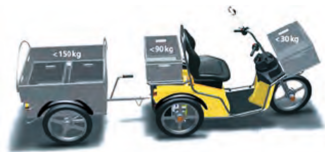
Il Kyburz DXP con la suddivisione sui singoli assi del carico massimo consentito di 270 chili.
