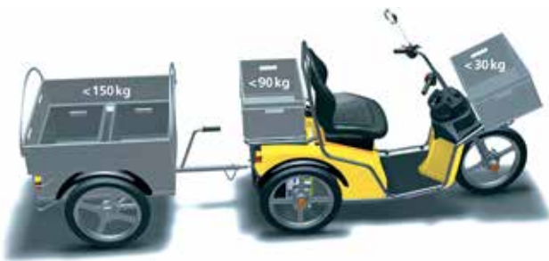
Le Kyburz DXP avec répartition de la charge utile autorisée (270 kilogrammes) sur les différents axes.
