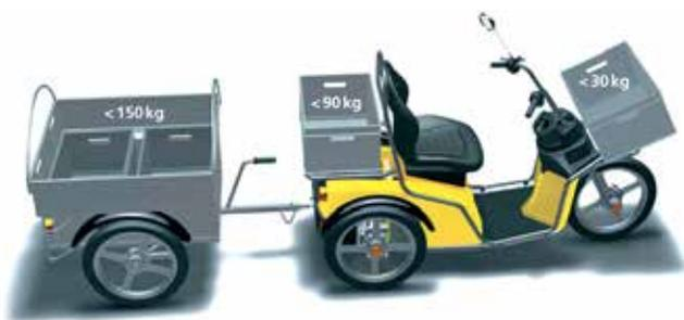
Der Kyburz DXP mit der Verteilung der zulässigen Nutzlast von 270 Kilogramm auf die einzelnen Achsen.
