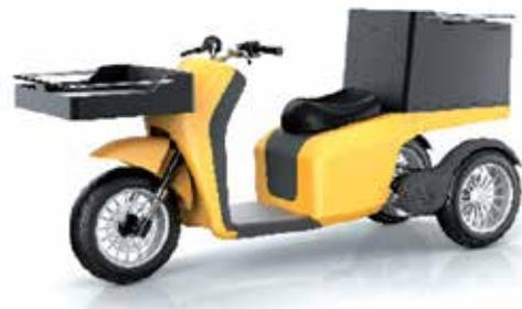
Wie der DXP verfügt der vR3 über eine Nutzlast von 270 Kilogramm. Als Besonderheit verfügt er über eine Neigetechnik, welche das Kurvenfahren erleichtert. Die Höchstgeschwindigkeit beträgt aber trotzdem 45 Kilometer pro Stunde.
