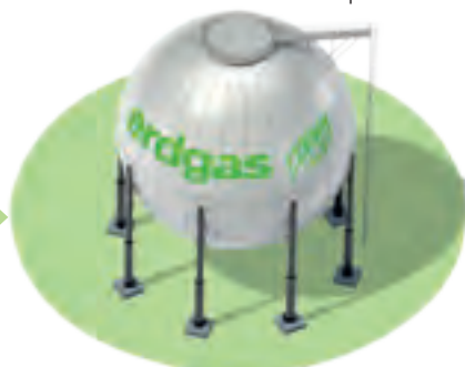
Réservoir de méthane sous pression
