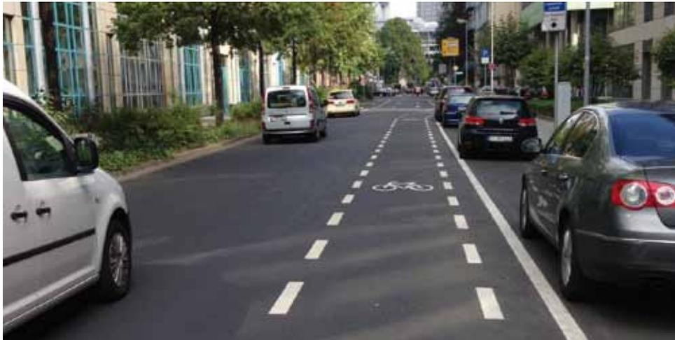
Schutzstreifen neben einem überbreiten Fahrstreifen Abb. 11
