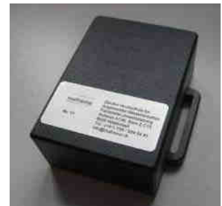
Abbildung 41: Ansicht GPS-Loggers „mafaina-2“, Grösse: 49x71x26.5 mm
