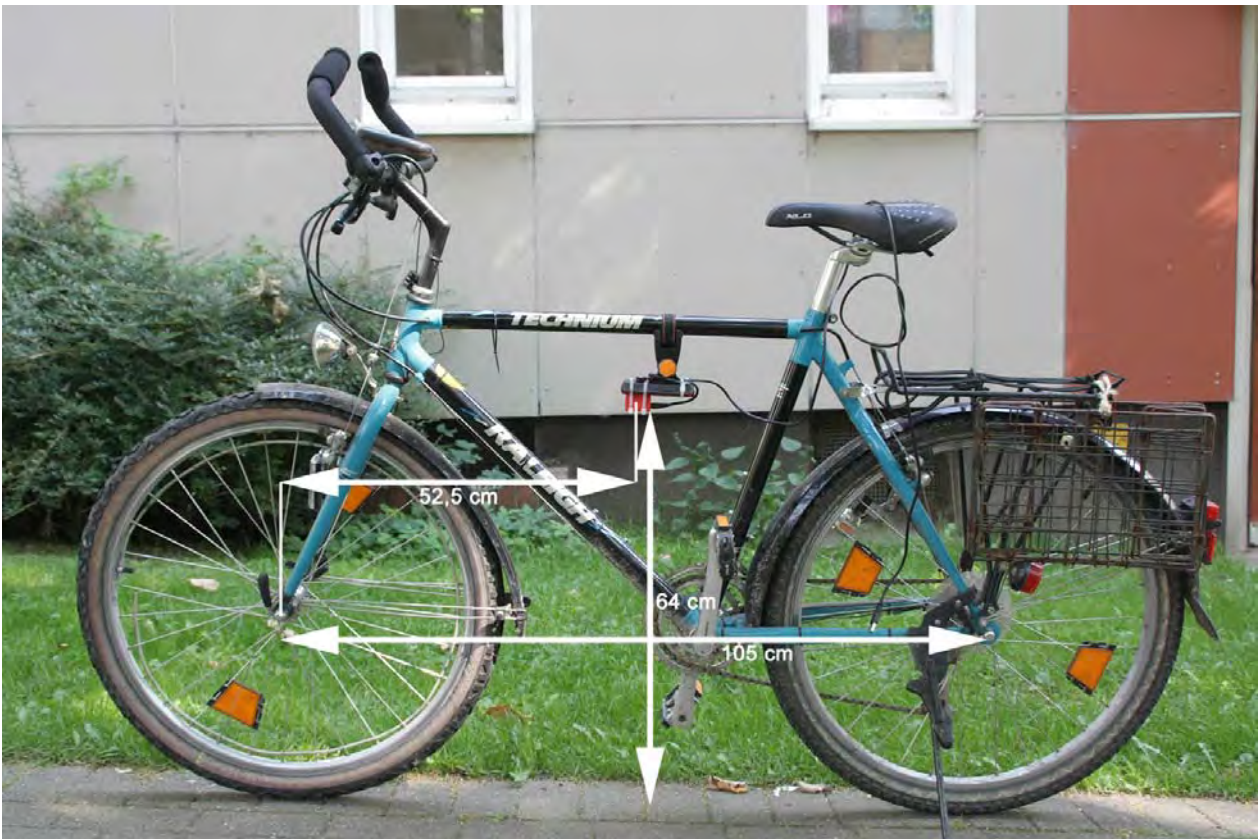
Abb. 10: Messfahrrad mit Montageposition des Beschleunigungssensors.
