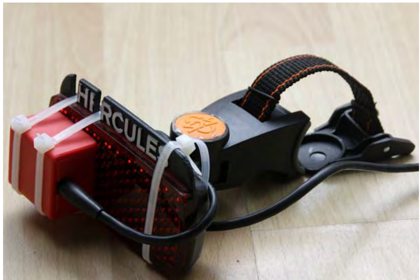
Abb.9: Selbst gebastelte Fahrradhalterung zur schnellen Montage des Beschleunigungssensors.
