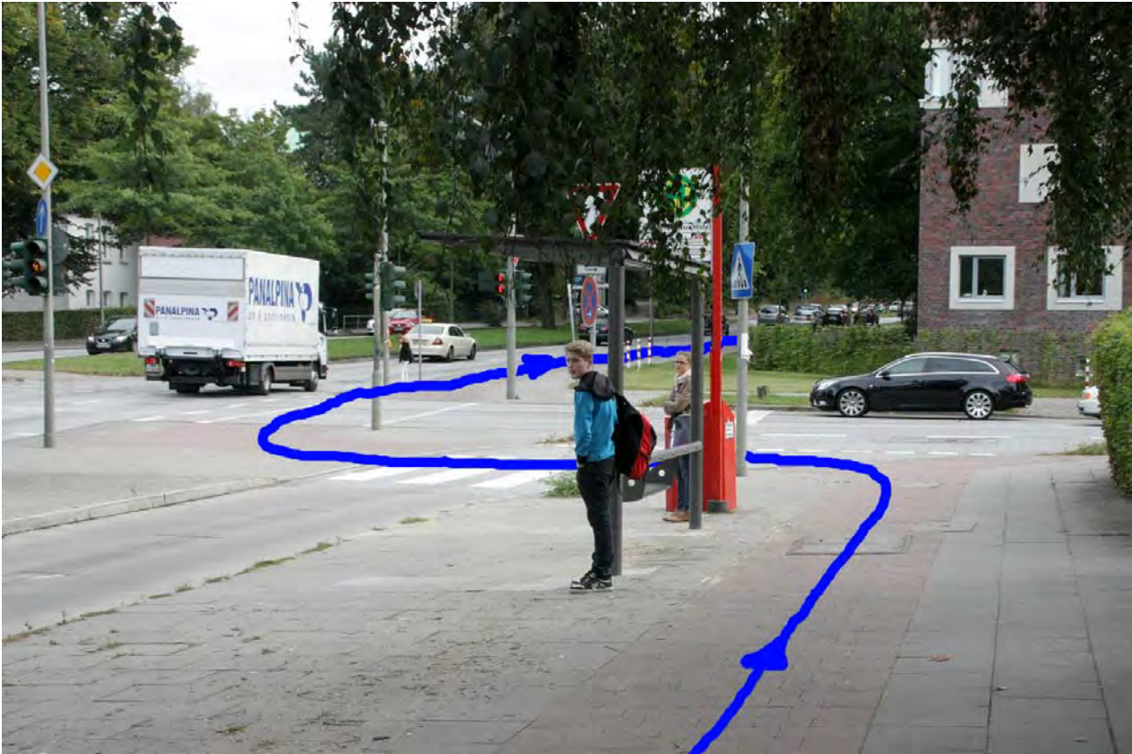
Abb. 26: Umwegige Führung und schlechte Sichtbarkeit des Radverkehrs um ein Wartehäuschen herum – Veloroute 5 West stadteinwärts, Sengelmanstraße Ecke Alsterdorfer Straße.
