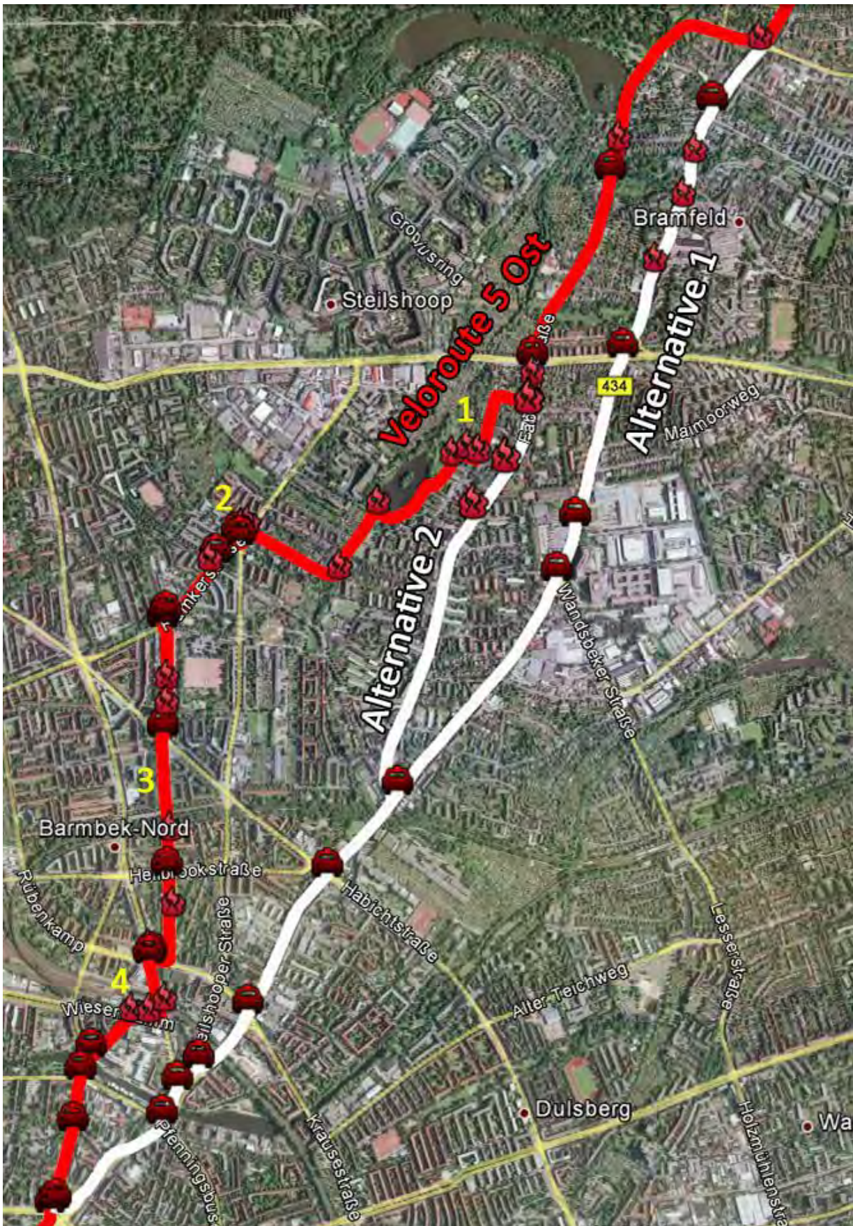
Abb. 35: Vergleich des gegenwärtigen Verlaufs der Veloroute 5 Ost mit den Alternativen 1 (Bramfelder Chaussee) und 2 (Fabriciusstraße). Feuersymbole: Problemstellen, Autosymbole: LSA. Beschreibung der ausgewählten Problemstellen 1-4: siehe Tab. 25.
