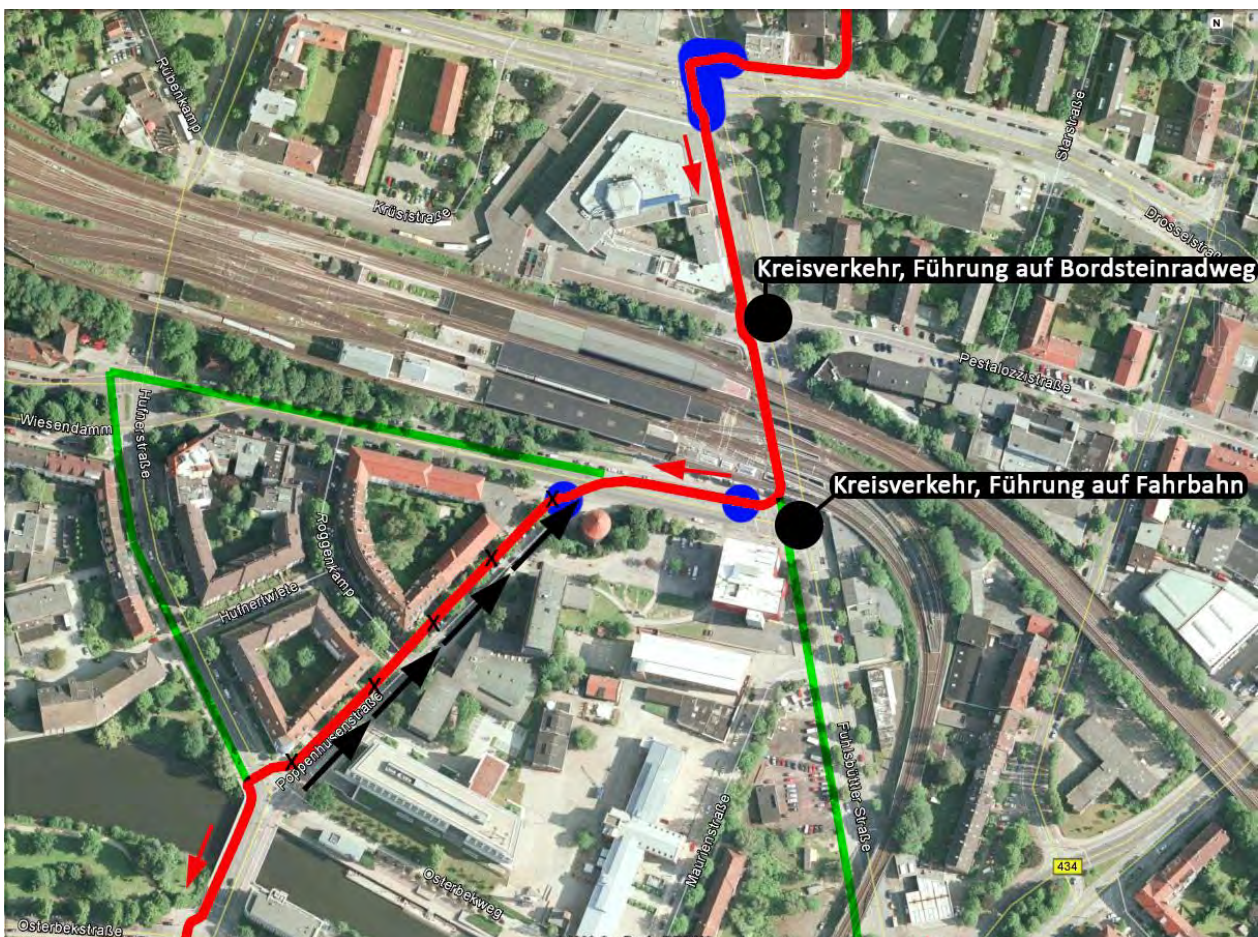
Abb. 34: Veloroute 5 im Bereich der Haltestelle Barmbek. Rot: Verlauf der Veloroute 5 Ost in Hinrichtung, schwarze Pfeile: Einbahnstraßenfahrtrichtung der Poppenhusenstraße, grün: Umfahrungsmöglichkeiten der gesperrten Einbahnstraße, blau: Orte mit potentiellen Behinderungen durch viel Fußverkehr, Kreisverkehre: Neubauten, die auf dem Luftbild noch nicht zu sehen sind.
