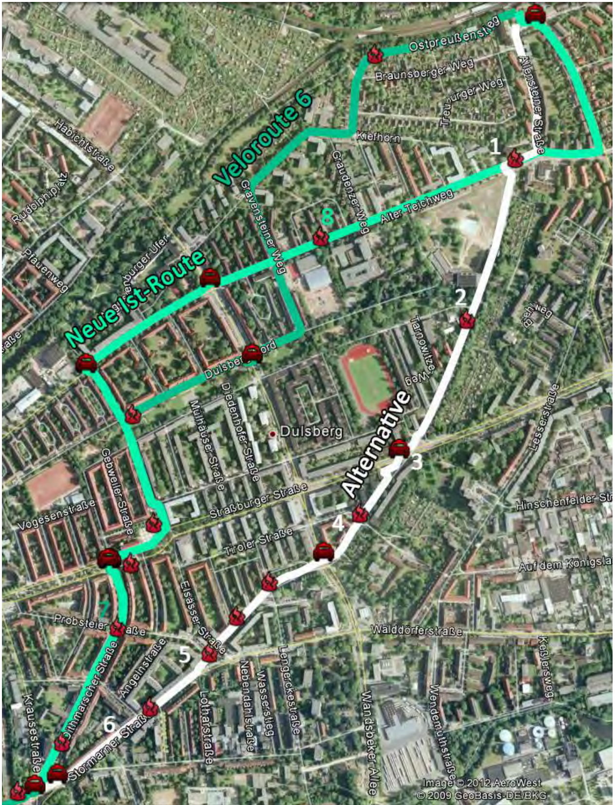
Abb. 39: Vergleich des gegenwärtigen Verlaufs der Veloroute 6 (Hinrichtung) im Dulsberg mit der neuen Ist-Route und der Alternativroute. Feuersymbole: Problemstellen, Autosymbole: LSA. Beschreibung der ausgewählten Problemstellen 1-8: siehe Tab. 36.
