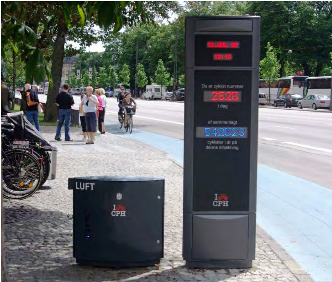
Abb. 60: Fahrrad-Zählstelle (rechts) für Statistik - gleichzeitig eine Motivation zum Radfahren und Erhöhung der Präsenz des Radverkehrs in der Öffentlichkeit. Links: öffentliche Luftpumpe. 34
