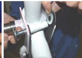
Il faut « écarter » un peu les côtés de l'attache BICI... pour laisser l'espace à 2 protections de caoutchouc
