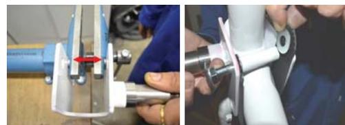
Il faut « écarter » un peu les côtés de l'attache BICI... pour laisser l'espace à x 2 protections de caoutchouc
