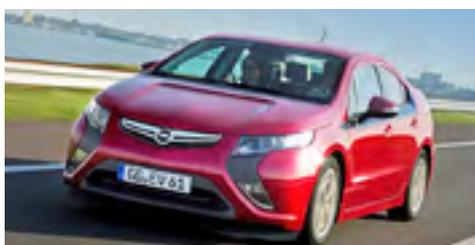
**Der Opel Ampera** ist ein Elektroauto mit Range-Extender. Nach 80 Kilometern produziert ein Generator zusätzlichen Strom für den Elektromotor.
