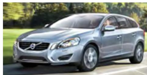
**Der Volvo V60** ist der weltweit erste Diesel-Plug-in-Hybrid. Bis zu 50 Kilometern können damit rein elektrisch zurückgelegt werden.
