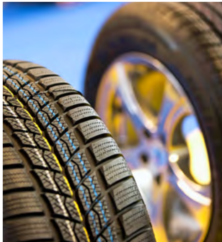
La résistance au roulement compte pour environ 20 % dans la consommation de carburant.
