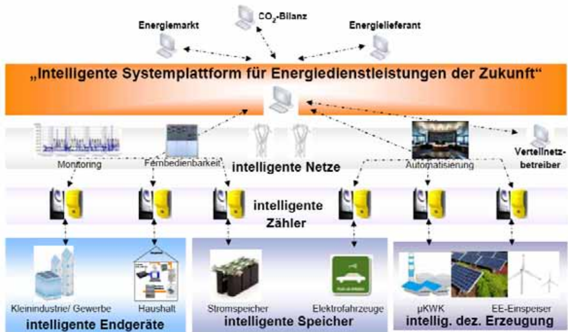
Figur 2: "Smarte" oder intelligente Netze, Zähler, Endgeräte, Speicher und Erzeugung = Smart Grids
