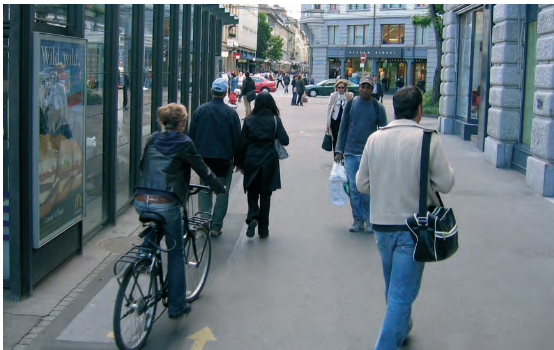
Die Velofahrenden werden hinter einer Tramhaltestelle hindurch über eine stark frequentierte Gehfläche geleitet, was den Komfort sowohl für die FussgängerInnen als auch für die Velofahrenden senkt.
