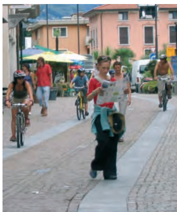
Ascona: Durch den gepflasterten Bereich führen zwei schmale Teerbänder. Diese Bänder kanalisieren die Velofahrenden, weil diese den Belag mit dem geringeren Rollwiderstand vorziehen.
