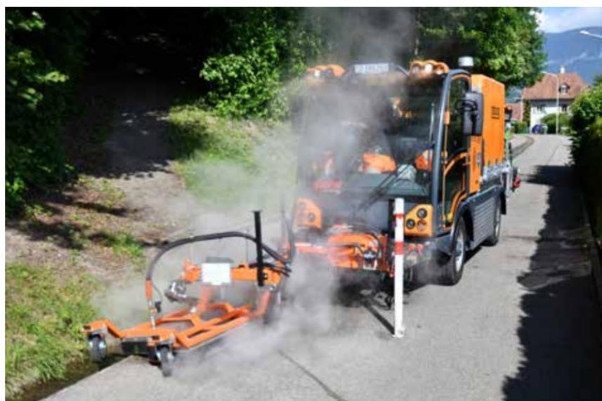
Unkrautbekämpfung mit dem Frontsprüher am Boschung-Pony...
