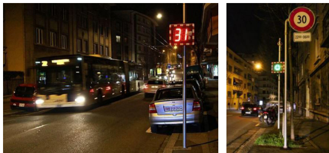
Fig. 6 : Essai in situ à l'Avenue Vinet, Lausanne (2017-2019) : introduction d'une limitation à 30 km/h la nuit. La mise en place d'un radar pédagogique favorise le respect de la vitesse maximale autorisée
