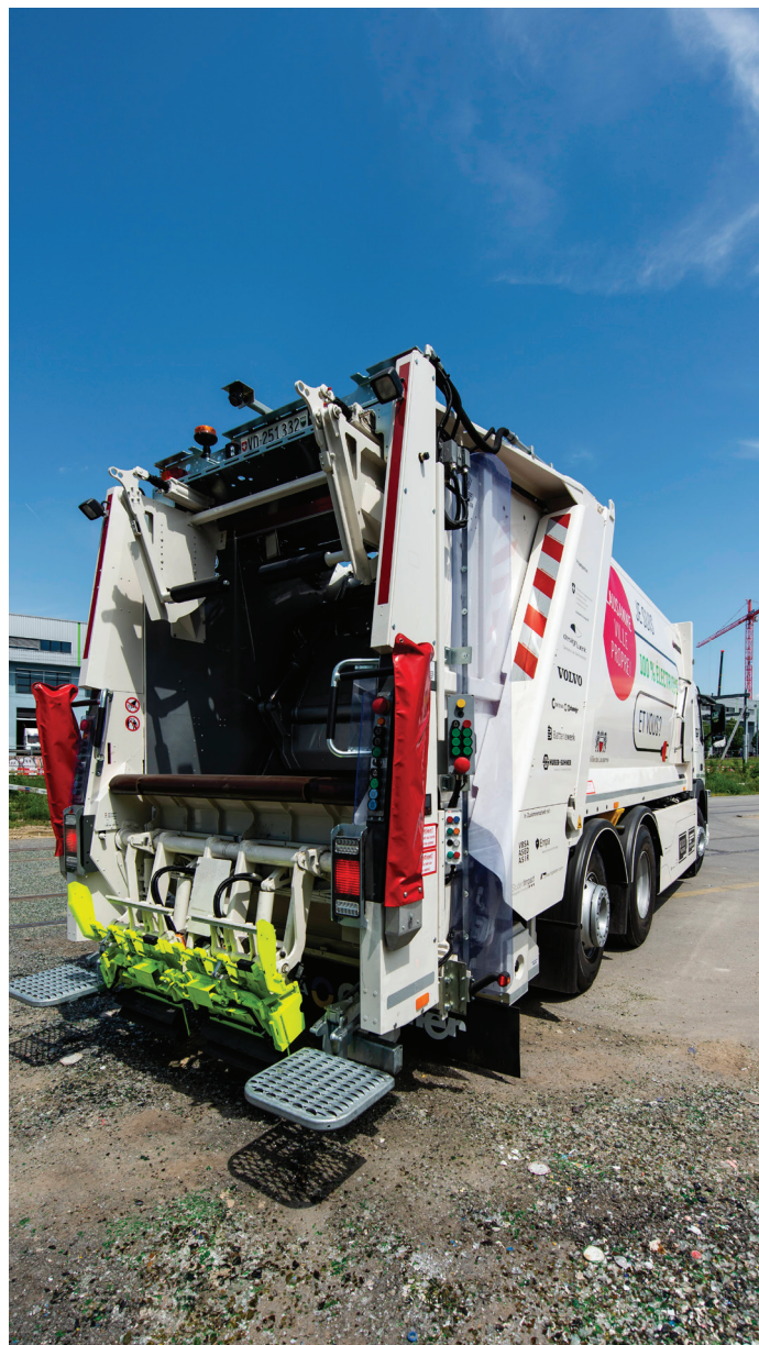
Das Ladesystem ist so konstruiert, dass zwei kleine Container unabhängig voneinander entladen werden können. Foto : Marino Trotta/ Stadt Lausanne
