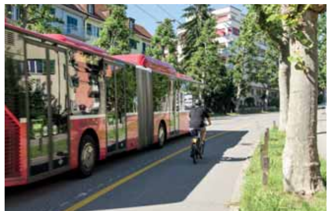
Aufgrund Steigung: Markierung eines Radstreifens anstelle Umweltspur, damit kann ein gefahrloses Überholen gewährleistet werden.
