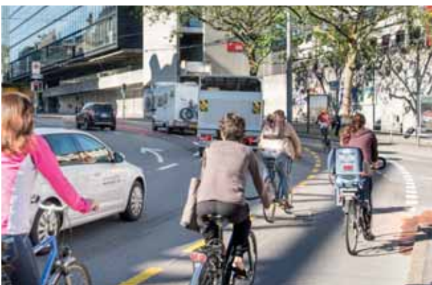
Durchgängiger und ausreichend breiter Radstreifen ( 2.50 m) beim Bollwerk. Der Radstreifen garantiert hier einen ausreichenden Abstand zum motorisierten Verkehr und die notwendige Kapazität in den Spitzenstunden.
