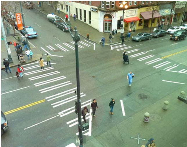
Fig. 1 : Phase „tout piéton” avec traversées en diagonale (Pedestrian Scramble) à Seattle (USA)
