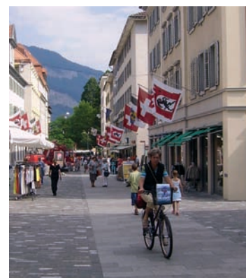
Chur, Poststrasse: Der Plattenbelag in der Mitte soll die Velofahrenden leiten. Er wird von den Velos als Fläche für die Zirkulation genutzt. Die Randbereiche sind weitgehend ohne Velos.
