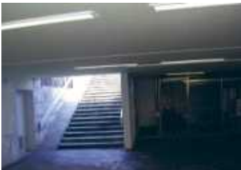
Schlechtes Beispiel: Unterführung mit nicht einsehbaren Nischen.
