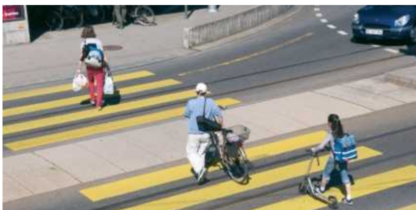
Fussgängerstreifen mit Warteraum in der Strassenmitte.
