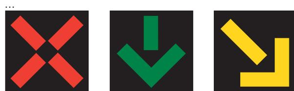
2.65 Sistema di segnali luminosi per la regolazione temporanea delle corsie
