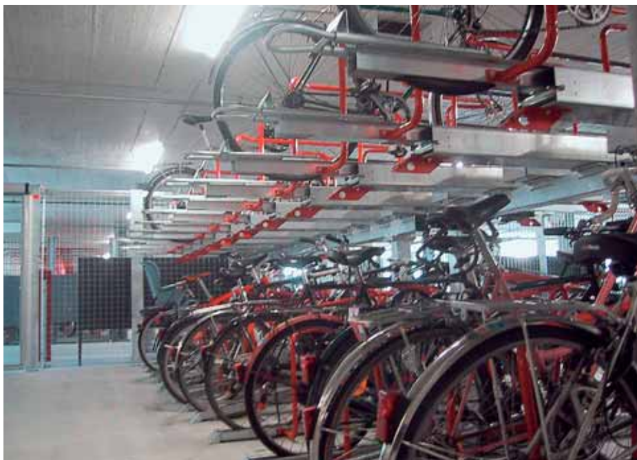
Mit dem Doppelparker, wie er in der Velo-Station Vélo am Bahnhof Biel installiert ist, können die Velos platz sparend abgestellt werden. (Bilder: Planum Biel AG)
